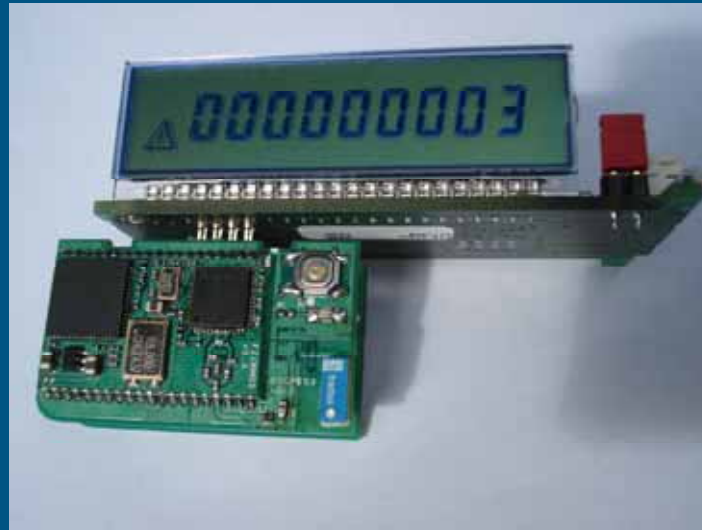
Radiomodul monteret sammen med gasmåle- rens PCB
